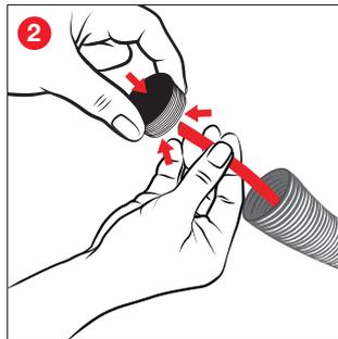
2 Stoßen Sie das im Rohr liegende Kabel durch die DICHTStopfen-Membran.
